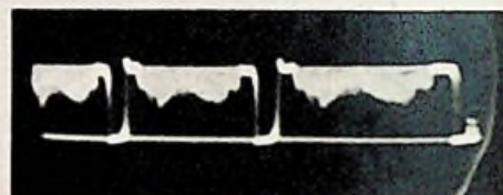
Abb. 18. Komplettes Zeilensignal bei Negativ-Abtastung
