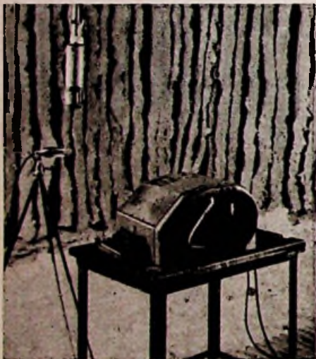
Fernschreibmaschine im schalltoten Raum. Auf dem Stativ: Kondensator-Mikrofon zur Messung der Lautstärke; über der Maschine: Neumann-Kondensator-Mikrofon für Spektromettermessungen
