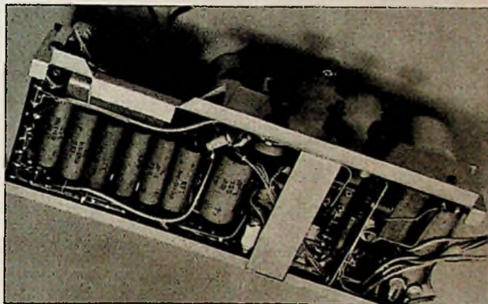
Kondensator abgelötet, um Lötösenbrett mit den Ausgleichswiderständen zu zeigen
