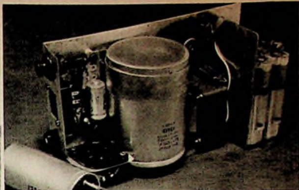
Abb. 18. Netzladeschnur. Abb. 19 (rechts). Stromversorgungsteil mit herausgenommenem Zerkhacker
